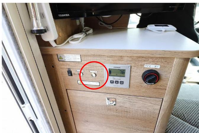
スイッチ ON でサブバッテリーから 100V 電源を使えます。
