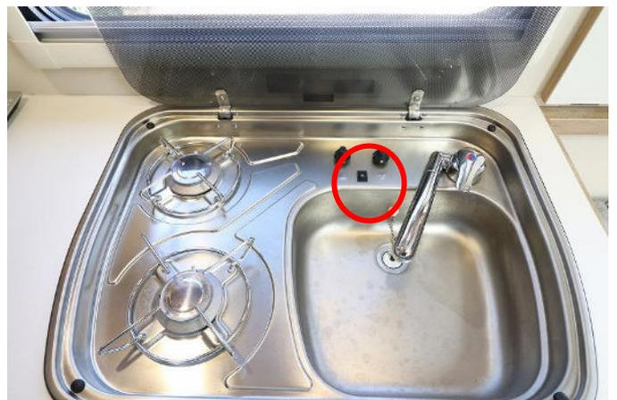
火力調節レバーを押し回してガスを出します。点火スイッチを押して着火。点火スイッチが使えない場合はライター等で着火してください。
