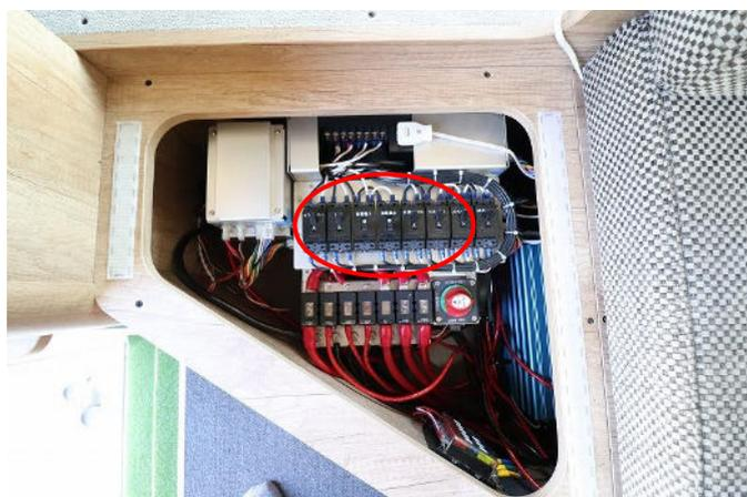
車内の電気が使えない場合は座席下のブレーカーが落ちていないか確認してください
