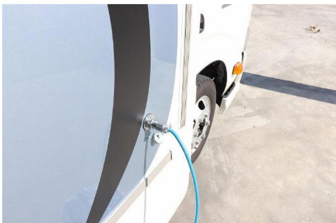
車両付属のコードを接続し、外部から電気を引けば車内で電気を使えます。
