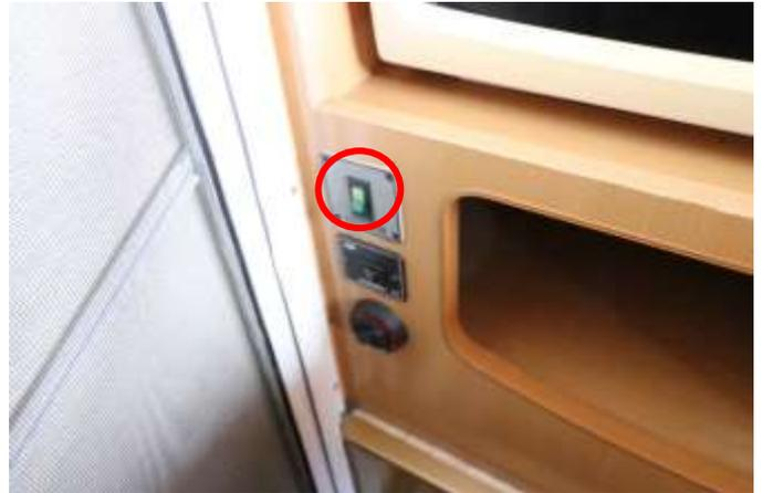
車内照明、水道ポンプ、換気扇使用時に ON
