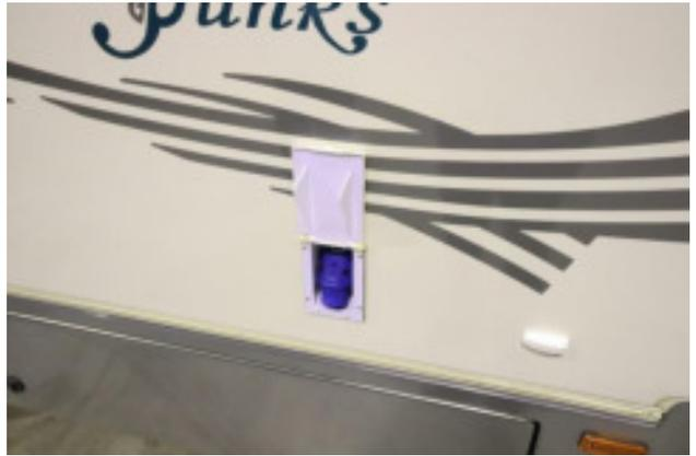
付属のコードを接続し、外部から電気を引くと車内でコンセントが使えます。
