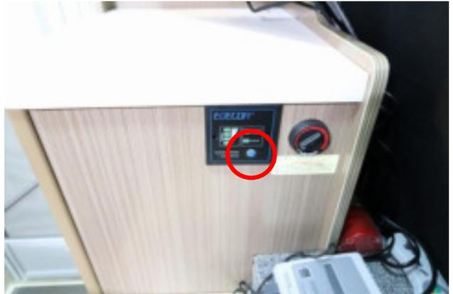
インバーターはサブバッテリーの 12V を 100V に変換する機器です。インバーターではホットプレート、炊飯器等の容量の大きな機器は使えません。外部電源をご利用ください。
