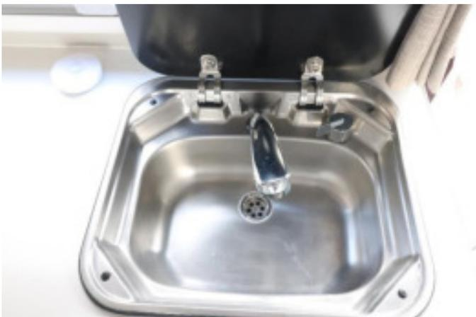
集中スイッチの水道ポンプ電源を ON。給水タンクに水を入れてください。水を入れずに蛇口を回すと水道ポンプのモーターが焼けてしまいます。
