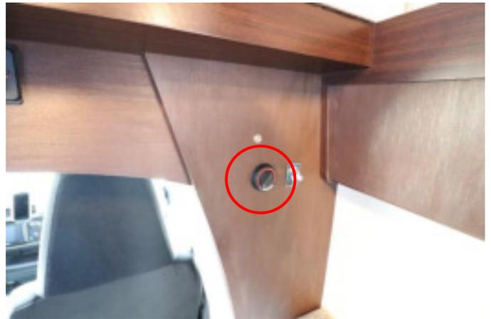
ダイヤルを最大にまわしてください。10 分くらいすると温風が出てきます。燃料はガソリンタンクのガソリンです。エンジンを切っても使えます。
