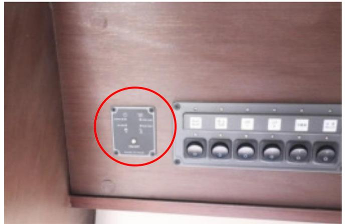
コンセントを使うときに ON。携帯電話の充電などできます。サブバッテリーから電気をとって、炊飯器、ホットプレートなどの電気使用量の多い機器は使えません。
