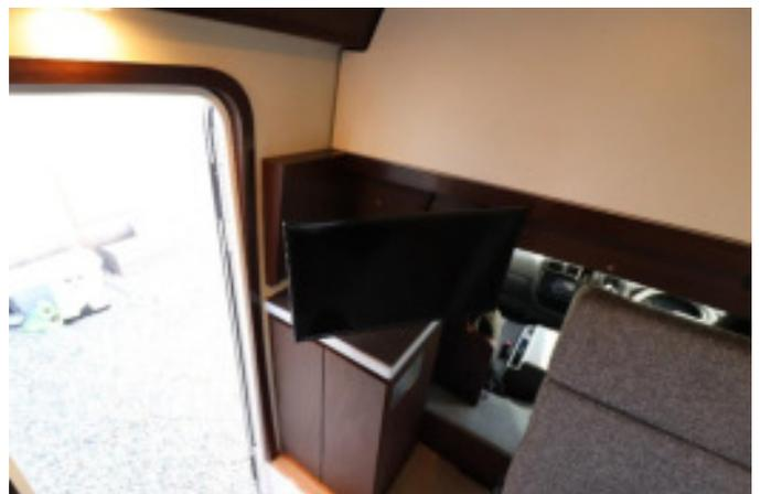
集中スイッチの電源 1 を ON。カーナビの映像が映ります。停車時にカーナビを使用するときは集中スイッ
