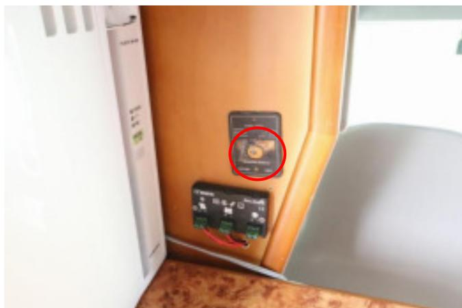
インバーターはサブバッテリーの電気を 12V から 100V に変える機器です。
