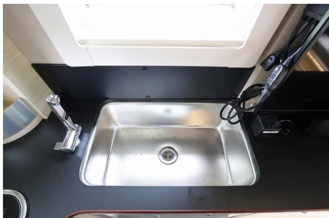
必ず給水タンクに水を入れて使用してください。水を入れずに蛇口を回すと水道ポンプが故障します
