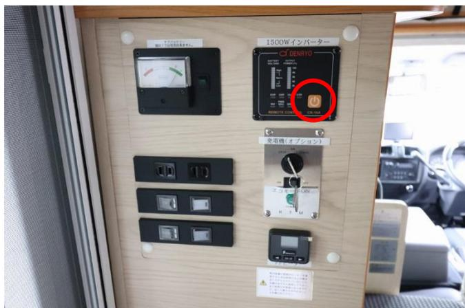
インバーターはサブバッテリーの 12V を 100V に変換する機器です。電源を入れると 100V コンセントが使
