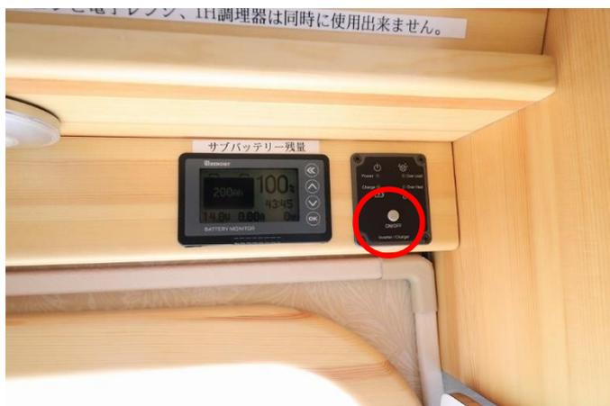
コンセント使用時に ON。インバーターはサブバッテリーの 12V を 100V に変換する機器です。電子レンジ、エアコン、IH コンロなど消費電力の多い機器は使えません。
