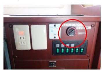
ダイヤルを最大に回して ON。10 分くらいすると温風が出てきます。温風が安定したらダイヤル回して温度調節してください。
