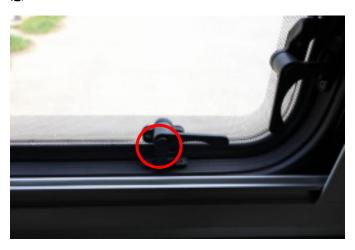
丸いボタンを押してロックを解除してレバーを動か します。アクリル窓は割れやすいので無理な操作はし ないでください。
