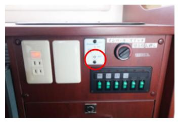
コンセント使用時に ON。インバーターはサブバッテリーの 12V を 100V に変換する機器です。
