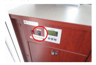
サブバッテリーの電気を使うときに ON
