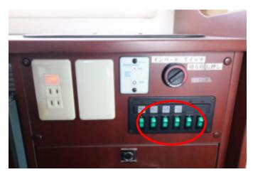
照明、水道ポンプ、天井換気扇のスイッチ
