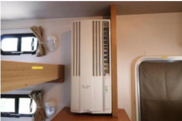
停車時は外部電源、発電機使用。走行中はインバーターで使えます。冷房専用。他の電気機器と併用しないでください。
