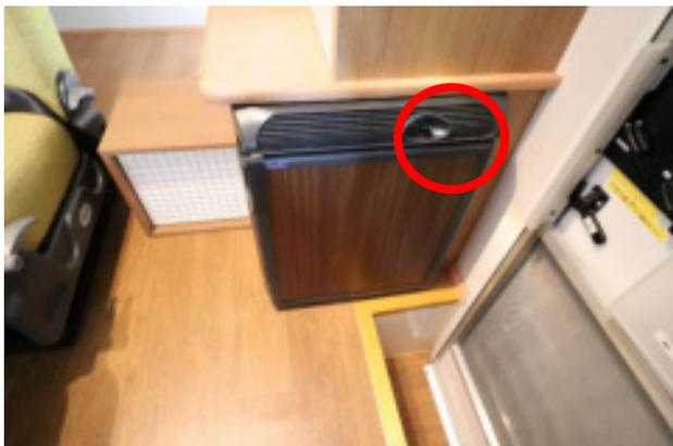
ダイヤルを回してスイッチ ON。電気を消費するので冷えたら OFF にしてください。
