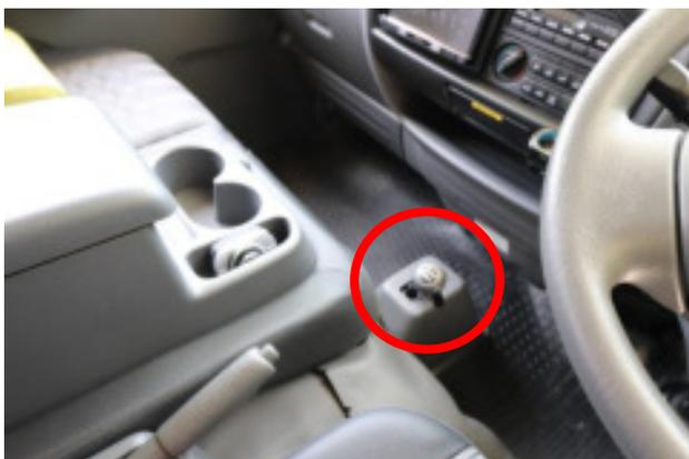
4WD は時速 60km 以上で走行禁止。火災の恐れがあります。停車している状態でレバーを切り替えてください。
