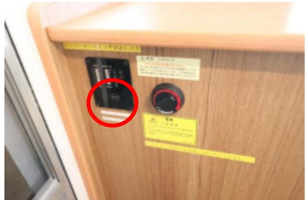
コンセント、エアコンを使用するときには ON。外部電源、発電機使用の際は OFF。インバーターはサブバッテリーの 12V を 100V 家庭用電源にかえる機器です。
