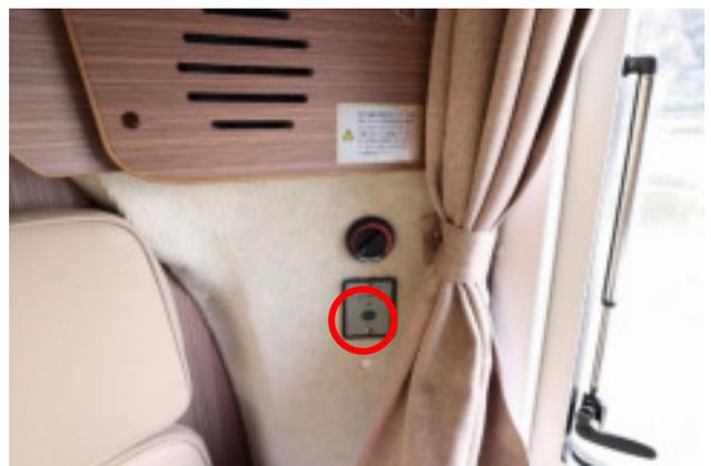
スイッチ ON でコンセントが使えます。インバーターはサブバッテリーの 12V を 100V に変換する機器です。炊飯器、ホットプレートなど電気を多く消費する家電製品は使えません。スマホの充電等にご利用ください。
