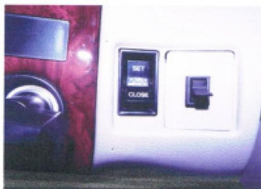
エンジンを『止めた状態』で、カーナビを使用するためのスイッチです。電源供給元は、『サブバッテリー』からになります。
