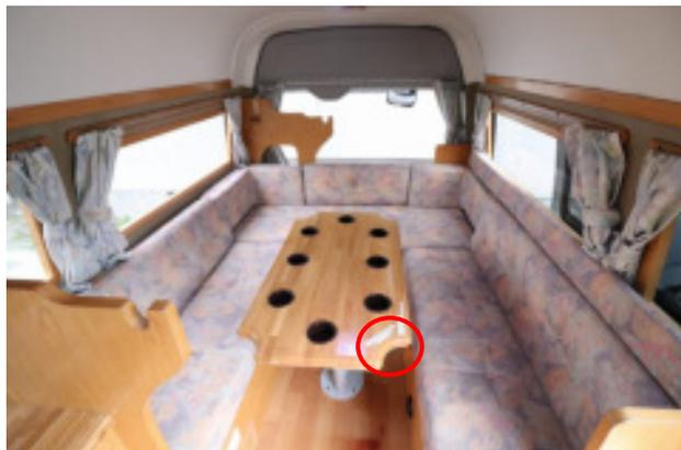
テーブル下のロックを解除してテーブルを押し下げます。
