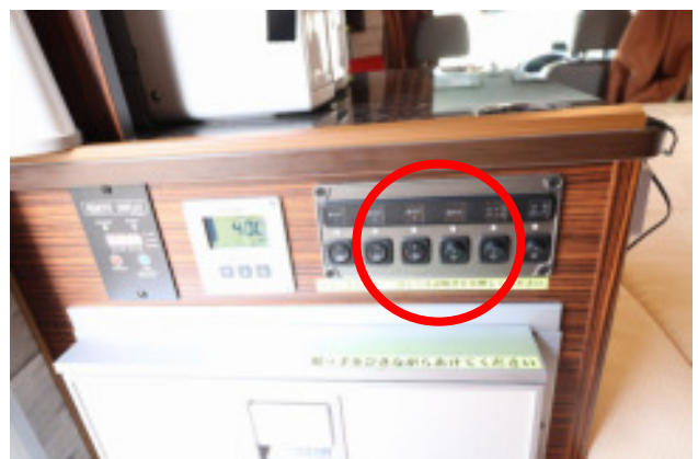
照明、水道ポンプなどのスイッチ
