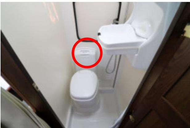
使用前にレバーを上下して洗浄水を流します
