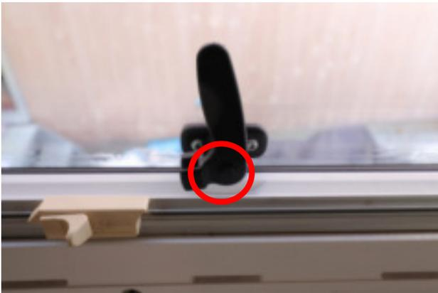
ボタンを押してロックを解除し、レバーを動かします。走行時は窓を閉じ、ロックをしてください。アクリル窓なので無理に開け閉めすると割れてしまいます。
