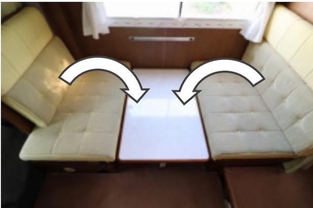
座席の間に置きます。背もたれを外してテーブルの上に置きます。
