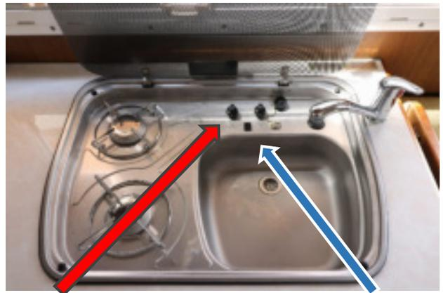
ダイヤルを押し回してガスを出し、点火スイッチを押して点火します。最初はガス管に空気が入っています。ガスが出てきたら着火できます。
