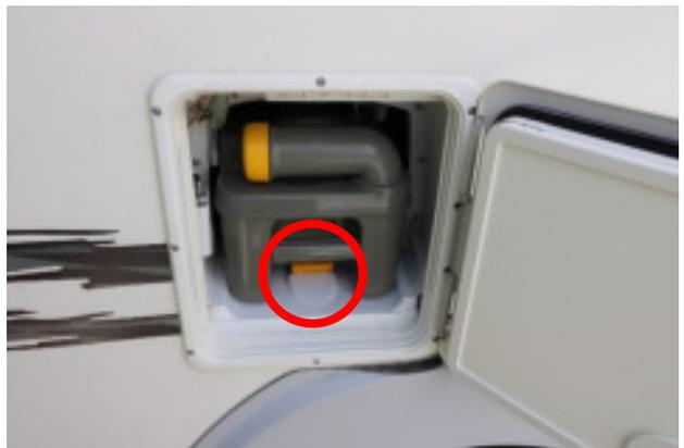
黄色のレバーを握りロックを解除してタンクを引き出します。
