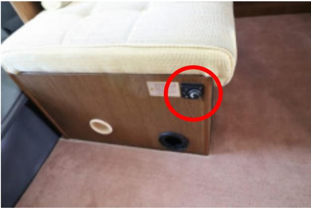
左上のボタンが ON 真ん中が OFF。ダイヤルで温度調節します。FF ヒーターはエンジン停止していても使える暖房です。燃料は燃料タンクのガソリンを使っています。
