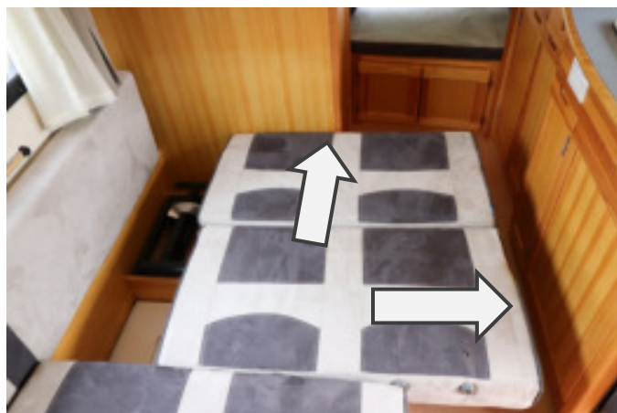
座席下の左のレバーで前後に、右のレバーで左右に動きます
