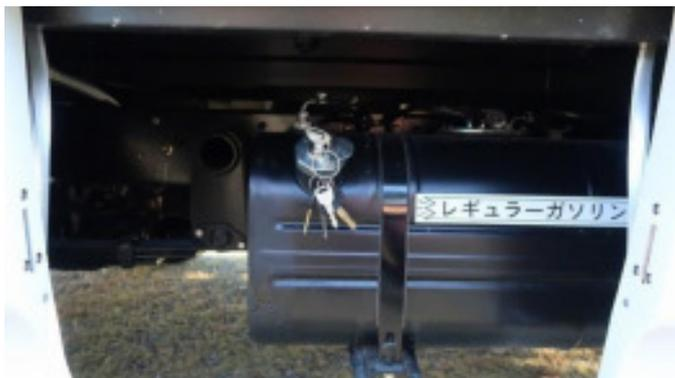
ガソリン給油口は運転席側にあります。ガソリントankのキャップはエンジンキーで開けます。
