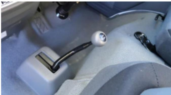
切り替える際は車を停止してください。4WD で 60 km/h 以上出さないで下さい。
