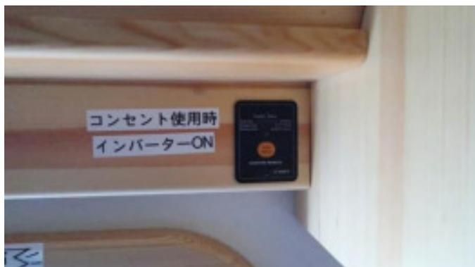
コンセントを使用する時はインバーターの電源を入れて下さい。インバーターはサブバッテリーから電気を取っているため、炊飯器、コ
