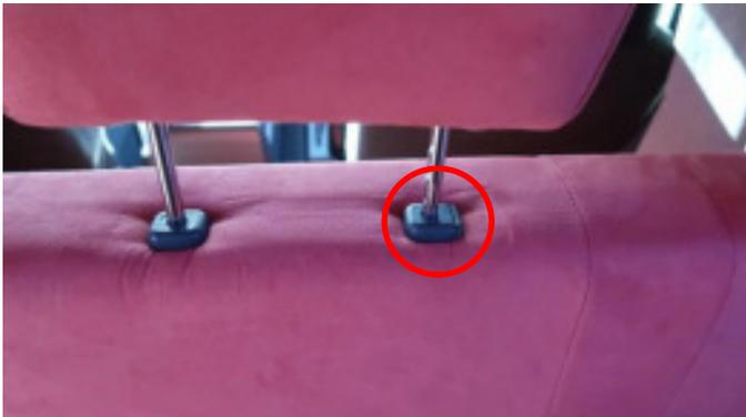
ヘッドレストを外します。ボタンを押してロックを解除します。
