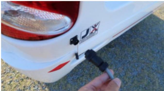
車両後部の差込口に車内設置の電源コードをつなぎます。一方を 100V 電源につなぐと車内でコンセントが使えます。
